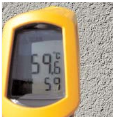
6.6 Oberflächentemperatur der VAWD (Y=25) am 18.08.08 um 16.30 h an der Sonne > 59°C.
