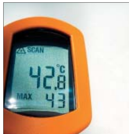
6.6 Oberflächentemperatur hellgrauer Farbton (Y=75) am 18.08.08 um 16.30 h an der Sonne bei < 43°C.
